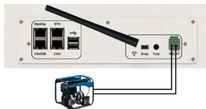
Le branchement ci-dessus permet de piloter le démarrage ou l'arrêt automatique d'un GE (Groupe Electrogène) en fonction de la tension du parc de batteries via un contact sec.
