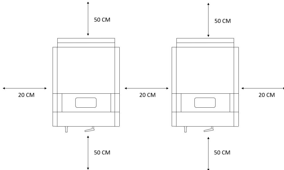
Important : Les onduleurs doivent être écartés de 20cm minimum et positionnés à une hauteur minimum de 50cm.
