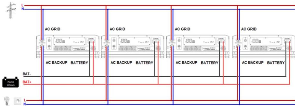
Jusqu'à 6 onduleurs peuvent être branchés en parallèle sur la même installation avec une limitation de 100A par phase avec le SmartMeter fourni. Le connecteur AC doit être connecté au réseau public, la batterie directement à la batterie, et le back-up aux consommateurs sécurisés.
