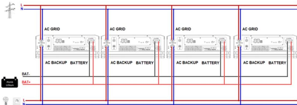
Fino a 6 unità possono essere collegate in parallelo sulla stessa installazione con una limitazione di 100A per fase con lo SmartMeter fornito.
