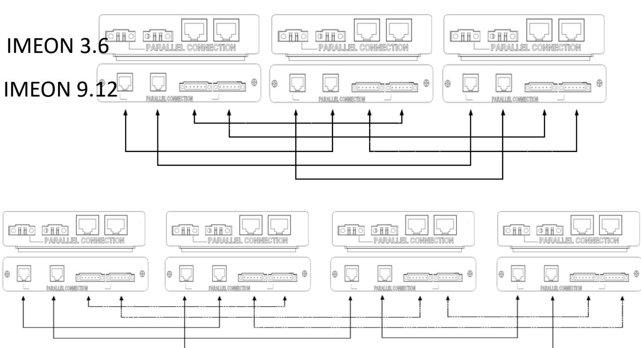
Les branchements de la plaque de connexion parallèle "PARALLEL CONNECTION" doivent suivre le schéma ci-dessus.
