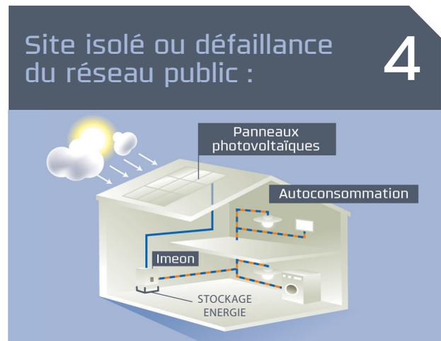
L'installation photovoltaïque alimente en journée les besoins en consommation et stocke le surplus dans les batteries pour une utilisation ultérieure.
